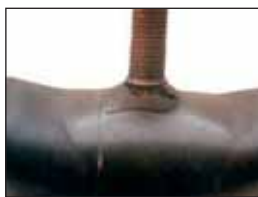
Stelo della valvola strappato
