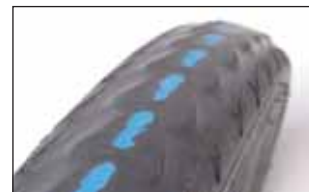
Lo strato di protezione antiforature è visibile. Lo pneumatico dovrà essere sostituito urgentemente.
