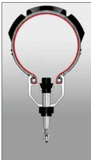
Sistema Tubeless: tenuta stagna tra pneumatico e cerchio.
