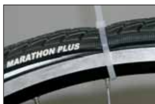
Una fascetta fermacavi può sostituire la terza mano.
