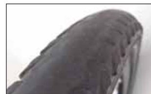
Il battistrada è consumato. La gomma è ancora presente. Questo pneumatico può ancora essere utilizzato.
