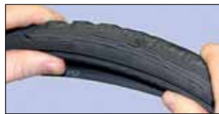
Crepe dovute alle sollecitazioni eccessive
